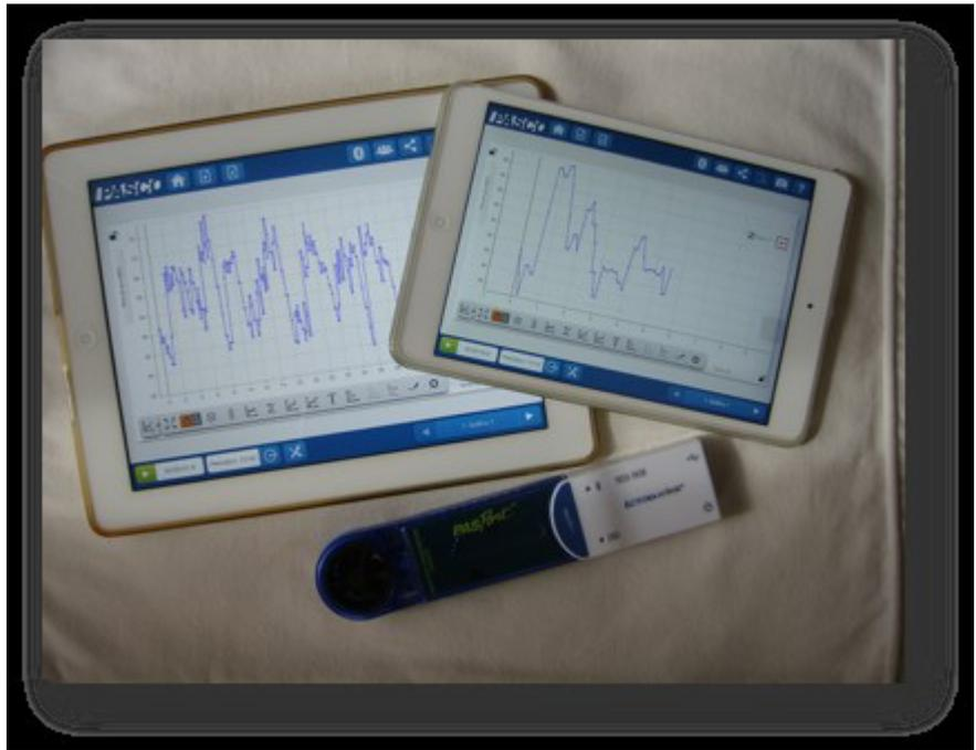
Figura 1. Tablets com o registo de medições do nível sonoro e velocidade do vento na aplicação *SPARKvue* (em cima), e sensor de velocidade do vento (em baixo)
