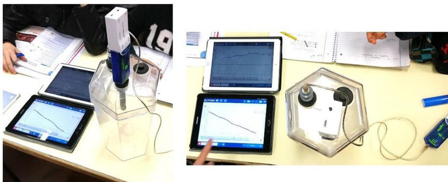
Figura 1. Aquisição de dados durante a combustão de uma vela, utilizando um sensor de CO<sub>2</sub> (PASPORT Carbon Dioxide Gas Sensor - PS-2110) e um sensor de oxigénio no ar (PASPORT Oxygen Gas Sensor - PS-2126 A), em conjunto com a app SPARKvue, instalada em tablets.
