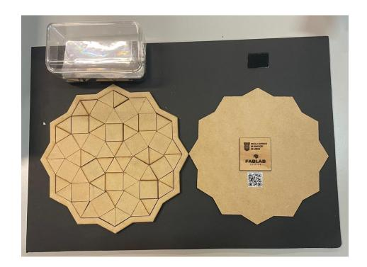
O puzzle "Geometrix 2D" é constituído por um tabuleiro, 66 peças (48 triângulos equiláteros e 18 quadrados) e foi construído em MDF através da técnica de corte a laser disponibilizada pelo FABLAB da ESELx.
